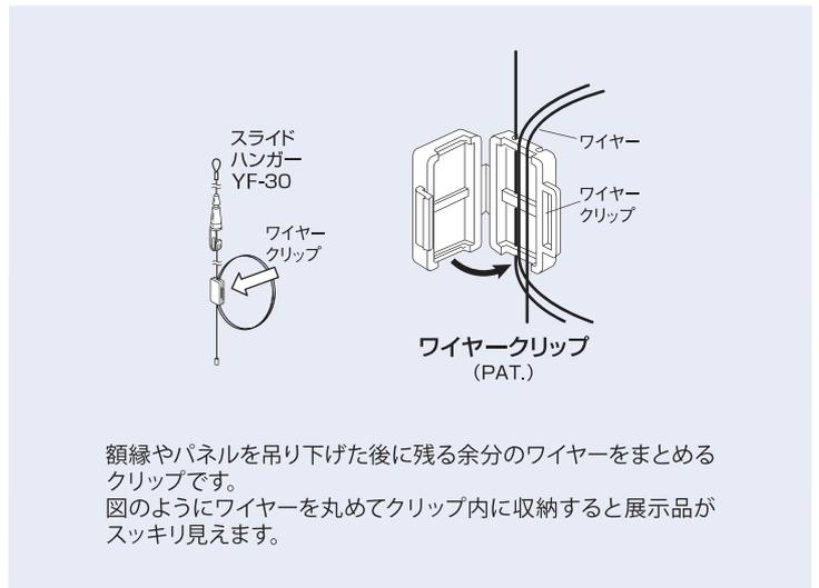
額縁やパネルを吊り下げた後に残る余分のワイヤーをまとめるクリップです。図のようにワイヤーを丸めてクリップ内に収納すると展示品がスッキリ見えます。
